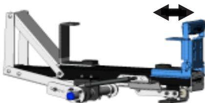
Deslice el mango a lo largo del mecanismo. El mango puede desplazarse siempre que ambos puntos de fijación permanezcan en el riel.
